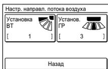
Когда внутренний модуль не имеет функции регулировки направления потока воздуха, [ГР] не отображается и поток воздуха нельзя установить.
