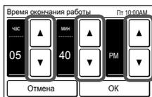
При касании [OK] дисплей вернется к экрану «Настройка диапазона».
