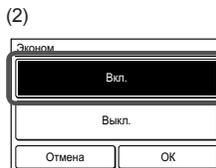
После касания [OK] данные передаются на внутренний блок, а затем дисплей возвращается к экрану «Дополнительные настройки».
